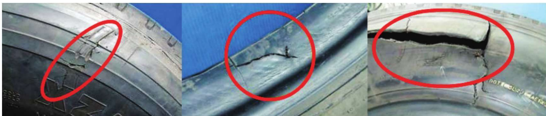
图1-9 轮胎表面裂纹
