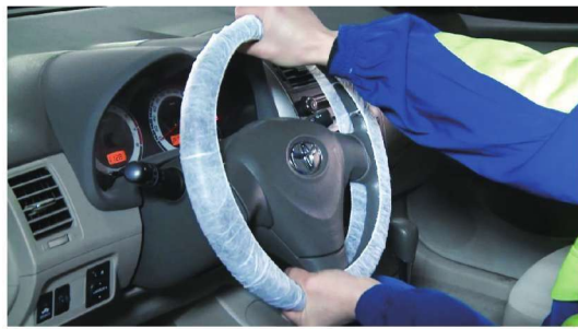
图1-14 方向盘垂直松动情况检查
