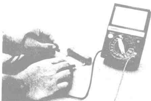
圖 1 - 8 正確之電阻測試法
