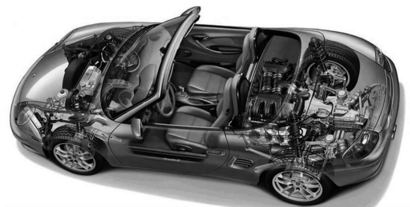
图 2-4 发动机中置后轮驱动
