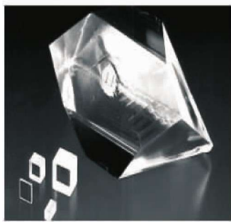
图 1-3 实验室制造的 w-氮化硼晶体
