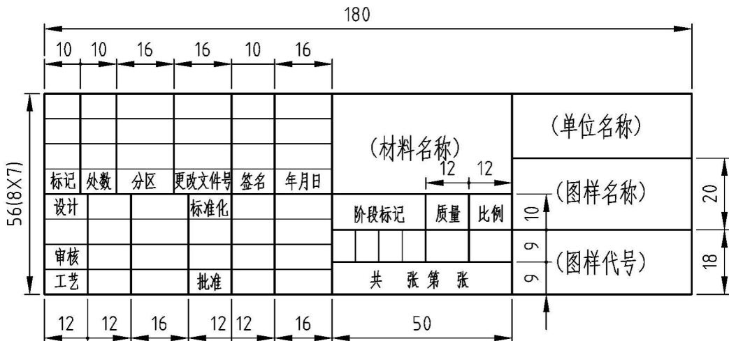
图 1-4 国家标准规定的标题栏格式
