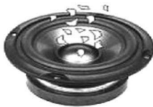
扬声器发声时小纸片上下跳动
