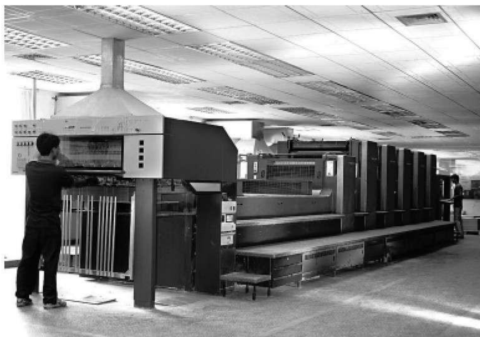
图 2 海德堡 CD102 采用了纸张规格预置技术
