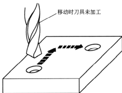
图 1-2 点位控制数控钻床加工示意图
