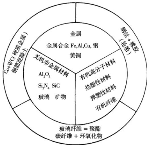
图 1.1 三大材料: 金属材料、无机非金属和有机高分子材料及几类可能的复合材料类型
