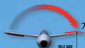
**滚转** 副翼控制飞机的横向滚转运动。
