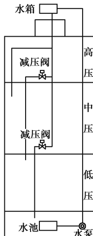
图 1.12 减压阀给水方式
