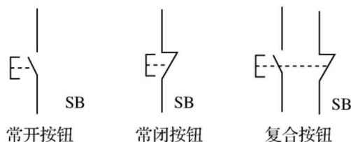
图 1-4 按钮开关的符号
