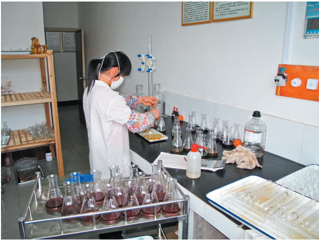
► 化验人员在进行土壤全氮含量的测定。
