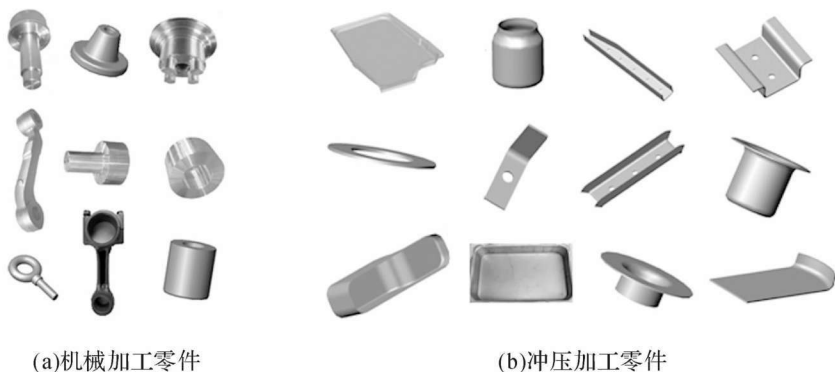
图 1.1 机械加工和冲压加工所得到的机械产品或零件
