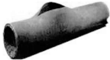
图 1-3 管道局部过热而引起的破裂
