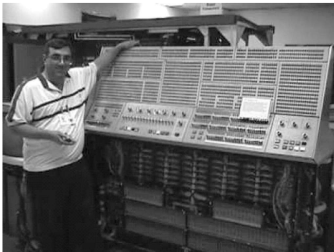
图 1-3 第一台集成电路计算机 IBM360
