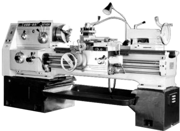
图 1.1 CA6140 型卧式车床的外形
