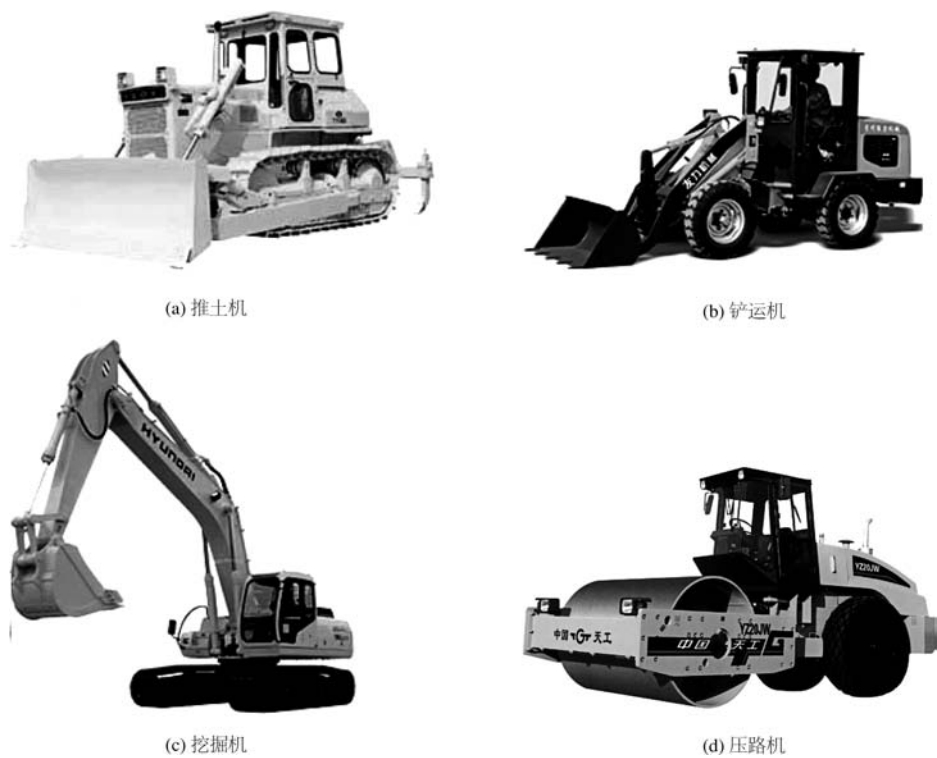
图 1-2 土方施工常用机械
