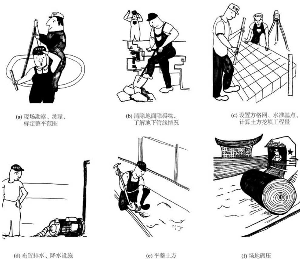
图 1-1 场地平整的工作过程示意
