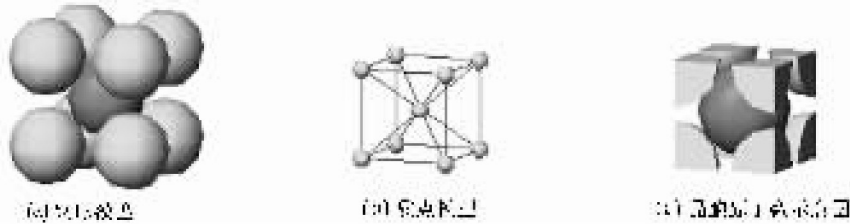
图 1.3 体心立方晶胞示意图
