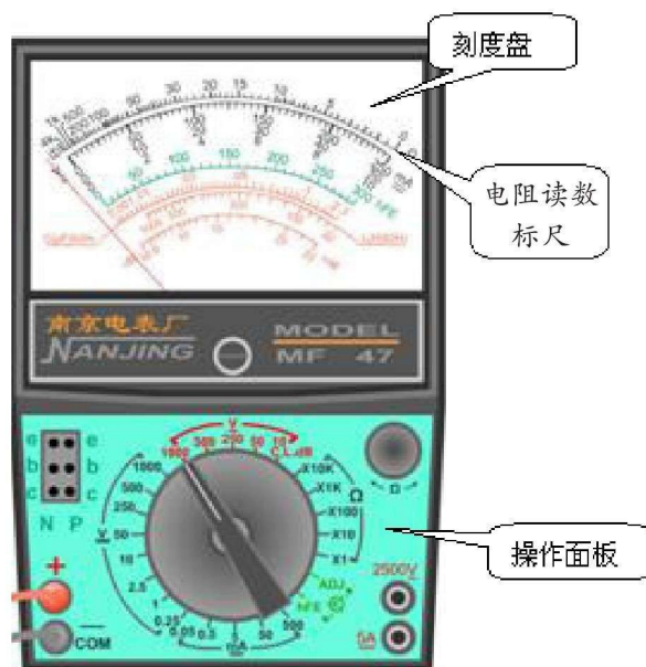
图 1-1-8 MF-47 型普通指针式万用表面板外观图
