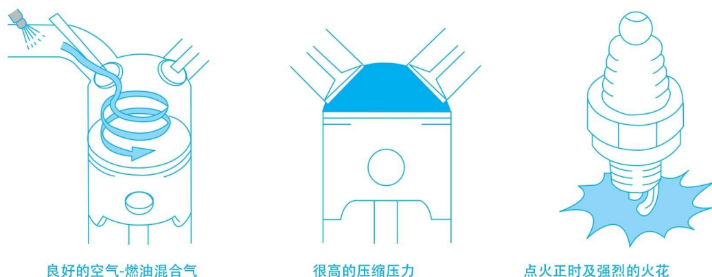
图 1-1 汽油发动机的动力三要素
