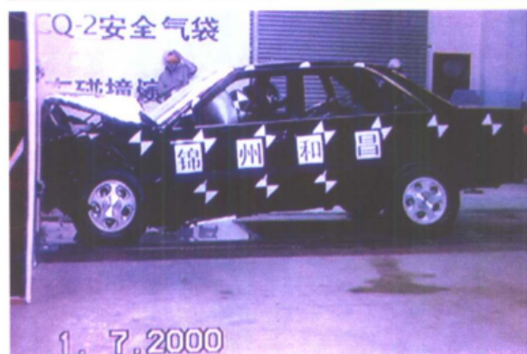
彩图1. 红旗轿车匹配国产气囊碰撞试验
