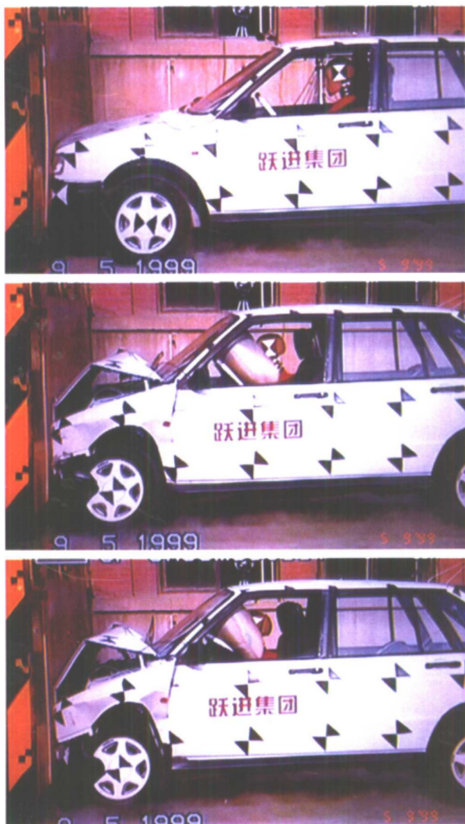
彩图 3. 跃进英格尔轿车匹配国产气囊碰撞试验
