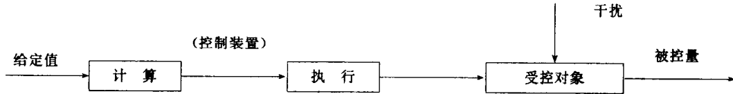
图1—4 按给定值操纵的系统原理方框图
