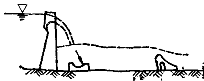
图 1-8 考尔达乌德拱坝消力池
