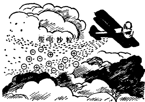
图 1-4 1921~1924年飞机撒播荷电沙粒消云试验
