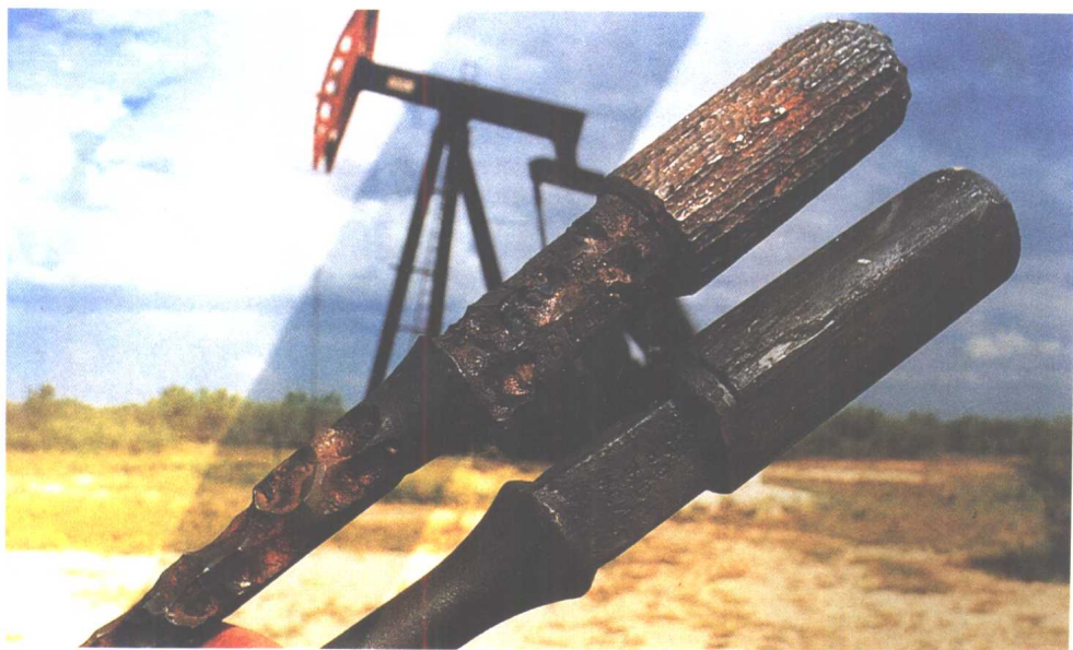
图 18 经过多相流磨蚀前后新、旧抽油杆的对比
