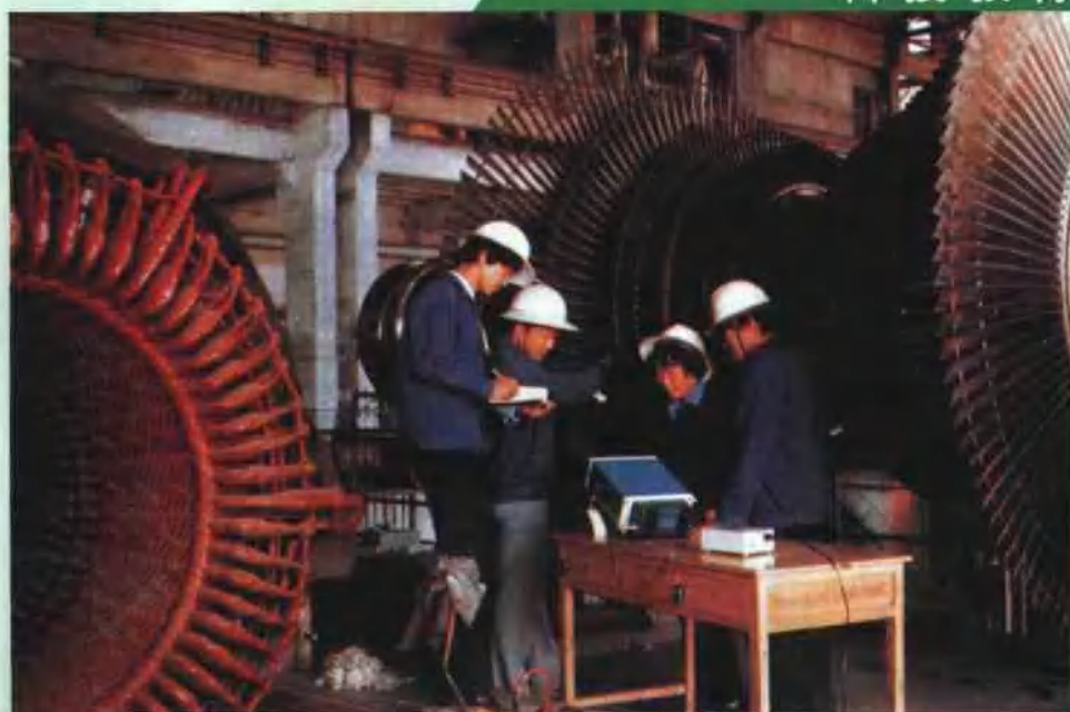
汽轮机叶片超声波探伤
