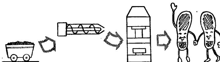
油压机的钢模里加压加热，使它充满模子。模子冷却以后，塑料凝成固体，一只光滑柔軟的塑料鞋底就生产出来了。
