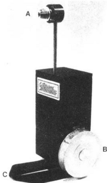
图 1-1 上巩膜静脉测压计。 A: 膜; B: 以 mmHg 为单位的刻度盘; C: 固定在裂隙灯上的脚板。
