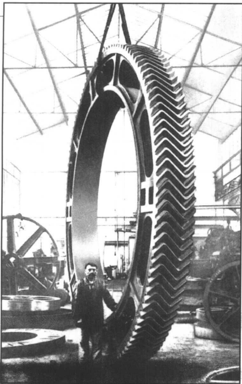
直径为6米的巨型人 字条纹齿轮，1905年生产
