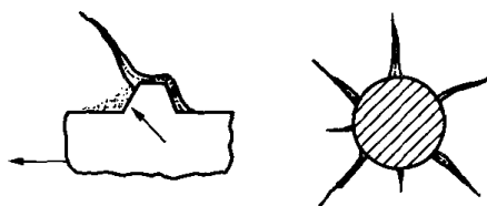
图 1-4 变形钢筋的劈裂破坏
