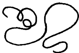
图 1-1 线型分子链形状示意图
