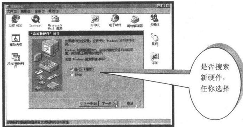
关闭计算机的电源，打开机箱，将“猫”插入主机板的任意空余插槽内，将电话线接头插入“猫”中标有“Line”的接头上，为了能使用电话机，还应将电话机的插头插入“猫”中标有“Phone”的接头上。重新装上机箱，在检查接线连接准确无误后，打开计算机的电源开关，启动 Windows 95，打开“控制面板”，单击“添加新硬件”，在“添加新硬件向导”中单击“下一步”。选中“希望 Windows 搜索新硬件吗？”下的“是（推荐）”按钮，单击“下一步”（见上图）。Windows 开始检测新硬件。检测结束后，单击“完成”。
