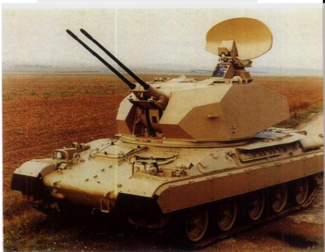
↑ AMX-30的改进型“军刀”式自行高炮,装有双联装30mm机炮和精密的火控系统
