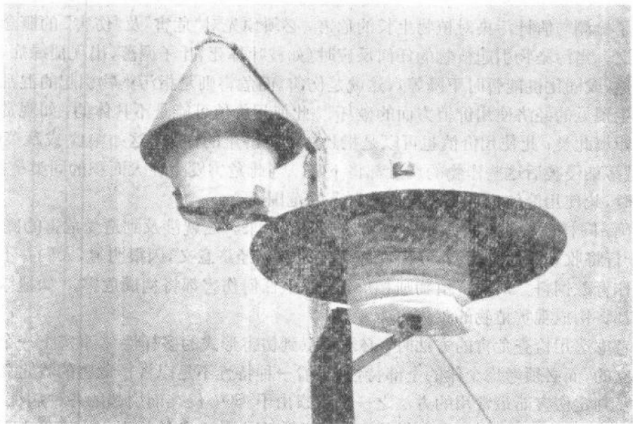
图3 固定式大气污染监测装置。 图左为 Leclerc 装置,用以检测 \text{SO}_2 ; 图右为 Harding-Desbaumes 装置,用以检测氟化物。
