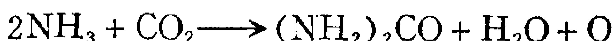
这一放热反应需要在高温( $>140^\circ\text{C}$ ,一般为 $180^\circ\text{C}$ )高压( $>140\text{kg/cm}^2$ )下进行。由于这是可逆反应，因此氨与二氧化碳不可能全部转化为尿素。在工业生产条件下，二氧化碳的转化率仅在50~70%之间。为了处理未反应的氨和二氧化碳，可以将合成熔融物加热分解，使成气体逸出。但要将氨和二氧化碳气重新压缩，会生成固体氨基甲酸铵(以后简称甲铵)堵塞管道和设备。为了克服这种困难，就出现了各种气体循环的流程。
