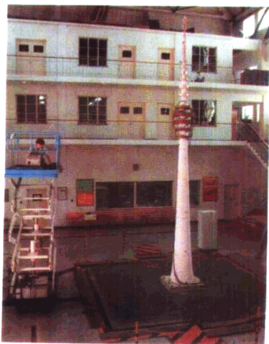
水利水电科学研究院模拟地震台 在进行中央电视台发射塔抗震试验
