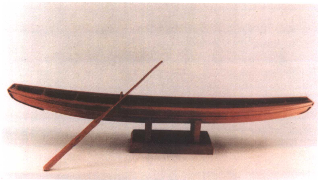
22.护卫兵船复原模型 明 据1958年小东梁山县宋金河故 道出土原件制作。原件长21.8 米,腰宽3.44米,最大舱深1.4 米,分为十三舱。模型长111厘 米,宽18.2厘米,高8厘米。
