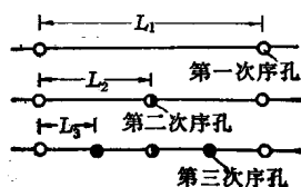
图 2-1 同一排灌浆孔 施工次序图
