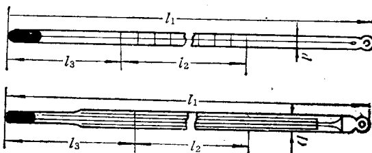
图 1-2 实验室玻璃温度计
