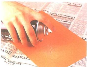
■ 使用喷胶时加垫废纸，以免喷胶洒落地面或桌面造成污染。
