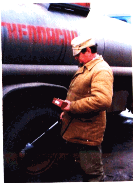
出入控制区的 车辆要接受沾 染检查
