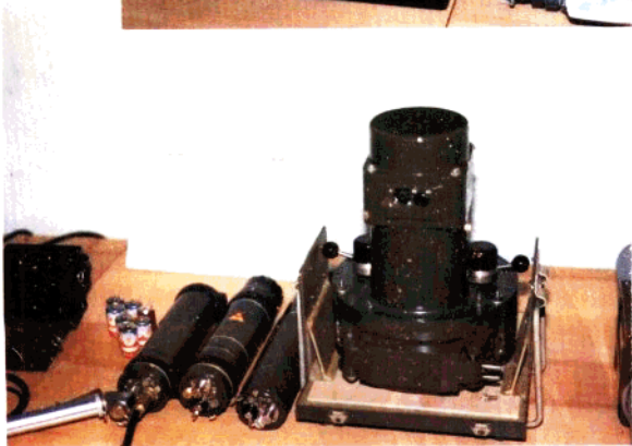
苏联民防向考察团展出的表面沾染测量仪
