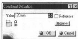
原来垂直长度 100mm 变成 120mm，如下图所示左；依次修改各尺寸值，将水平的长度设定为 150 单位长度，直至至原点距离分别设定为 75 及 60 单位长度，将矩形的中心定位在原点位置，如下图所示右。
