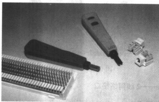
图 0.5 冲压工具以及 110 刀片和 CAT5 RJ45 插座
