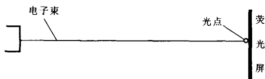
图 1.1.4 电子束轰击荧光屏形成光点示意
