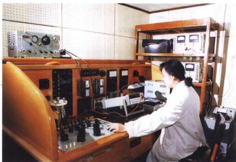
市计量测试所人员检测功率、电流、电压表 (1995年)
