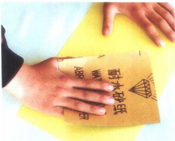
③用240号水砂纸轻轻打磨整个吹塑纸板表面。
