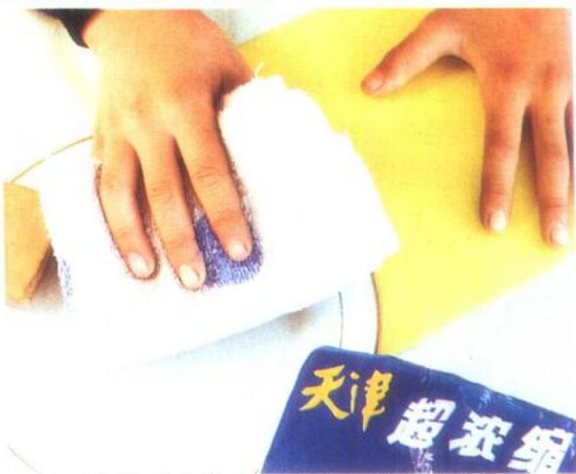
①用毛巾蘸洗衣粉水擦拭整个吹塑纸板表面。
