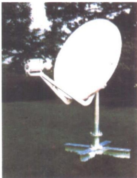
这是甚小天线地球 站的1.8米的微波天 线接收装置
