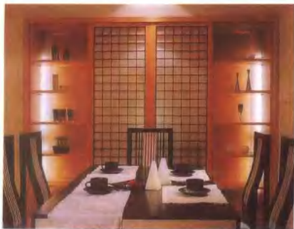
▲ 为求日式屏风的精细质感，餐厅底端的展示收纳柜兼端景台面，设计师特别延请精于日式木作的师傅，做出一道五厘米大小的格状滑轨门，中间是展示端景，其下为三个柜门收纳空间，两边因间接灯光打照，使得宣纸玻璃透着朦胧的美感。
