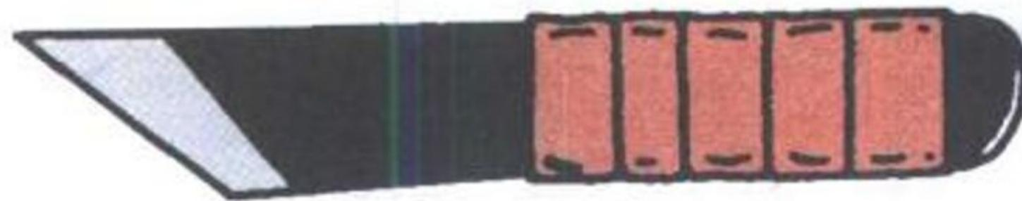
用来削木或竹。柄卷上乙烯绝缘带，可以根据孩子手大小调节柄卷带的长短。
